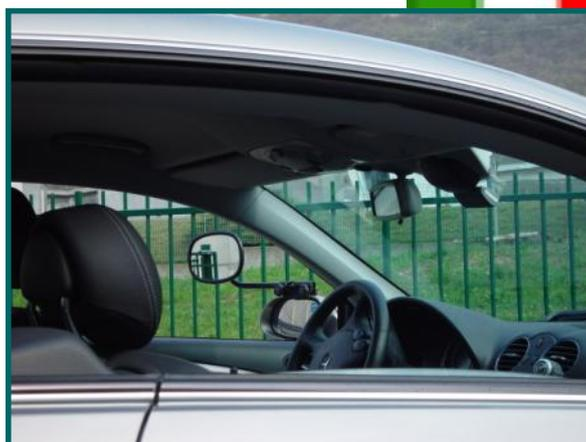
Il braccio in acciaio trattato a polveri e le bretelle di ancoraggio in materiale sintetico sono garanzia sulla durata di questo prodotto. Si presta facilmente ad essere regolato dall'interno dell'abitacolo.
